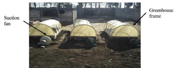
Gambar 2. Pengering Tenaga Surya dengan Sistem Terowongan
